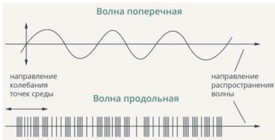
Рис. Поперечные и продольные волны
